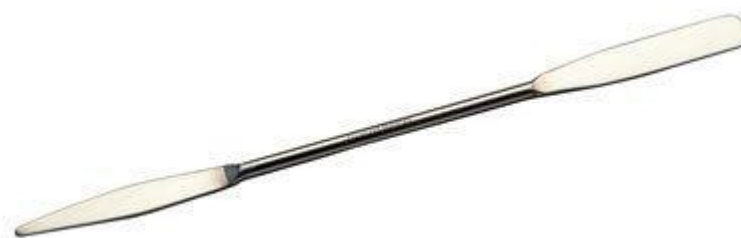
Figura 85 - Ejemplo de herramienta utilizada para limpiar los intersticios
